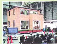
耐震実験の様子
